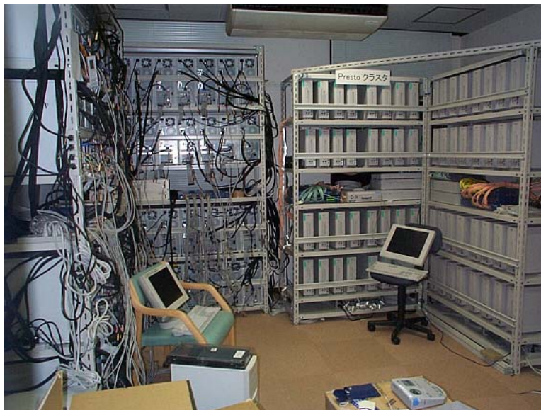
図 1: PC クラスタ (左: Pentium III 824MHz \times 128; 右: Pentium II 350MHz \times 64), 東京工業大学 松岡研究室
